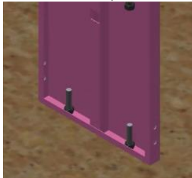
Figure 9: Fix the frame with the grounded/ Hình 9: Part đỡ chân để cố định khung chân với nền.
